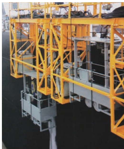
■ 造船工事に用ゴンドラ
