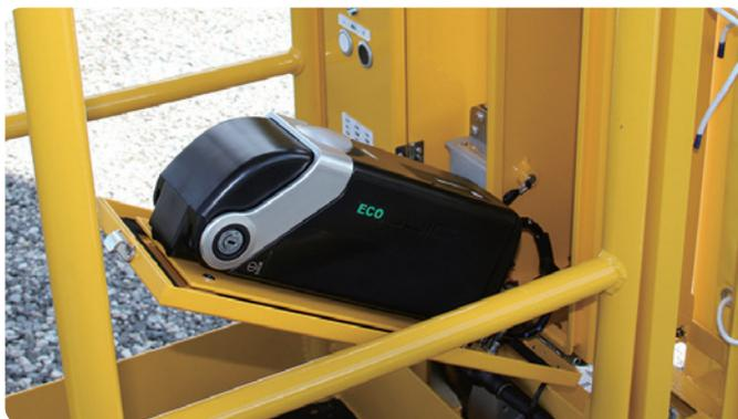
昇降は、バッテリーによる駆動。バッテリー残量が少なくなった場合は、スペアバッテリーに交換することで作業を継続することが可能です。
