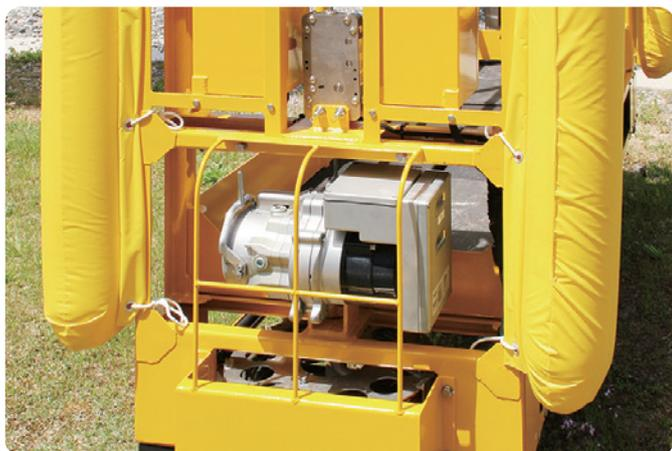
デッキは、昇降速度7m/min。低騒音、低振動で安定した昇降が行えます。
