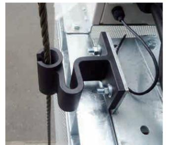
▲ ワイヤロープ振れ止め装置を搭載。
