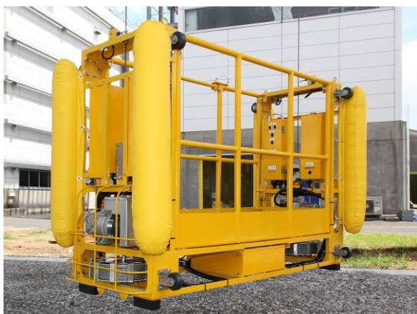
▲ゴンドラデッキ部
